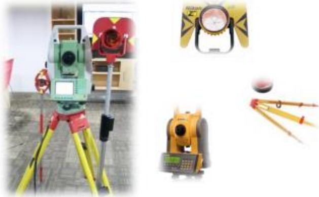
Imagen 6. Equipos de topografía (PRISMA, TRIPODE, ESTACION).
