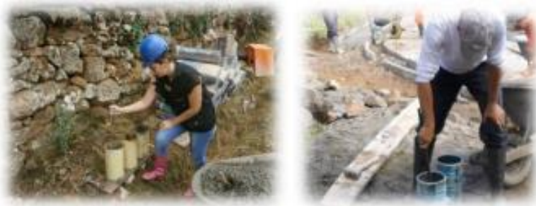
Imagen 17. Toma de muestras, testigos de concreto.
